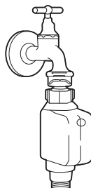
Tuyau d'arrivée d'eau de sécurité
