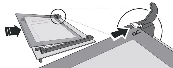
4. Instale novamente a extremidade superior: irá ouvir um clique, indicando que está bem posicionado. Certifique-se de que a vedação está segura antes de montar novamente a porta.
