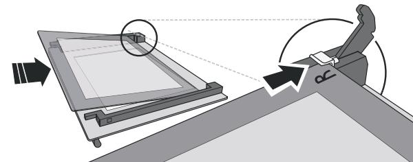
4. Vuelva a colocar la parte superior: un clic le indicará que se ha colocado correctamente. Asegúrese de que el precinto esté asegurado antes de volver a montar la puerta.
