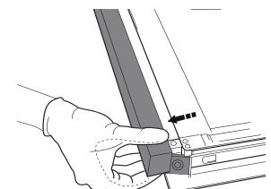
2. Levante e segure firmemente o vidro interior com ambas as mãos, removendo-o e colocando-o sobre uma superfície suave antes de proceder à sua limpeza.
